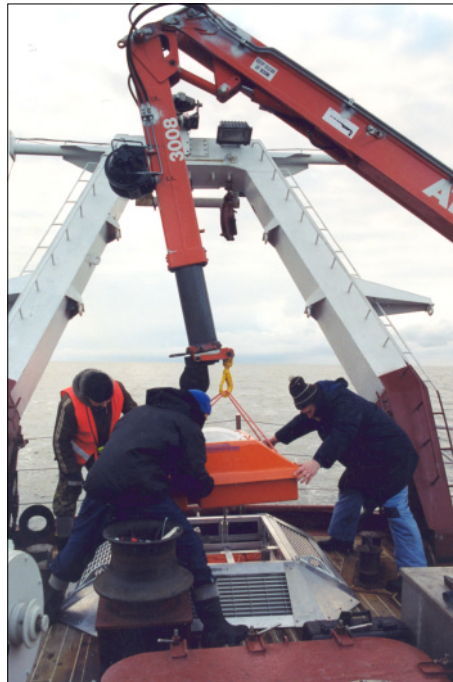
Fot. 9c. Przygotowania prądomierza ADCP (Acoustic Doppler Current Profiler) do opuszczenia na dno morza z rufy r/v „Oceania”
